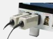
Каждый вход можно использовать для получения и отображения 1 аналогового сигнала с высоким разрешением или 8 цифровых логических сигналов – просто путём замены пробника.
